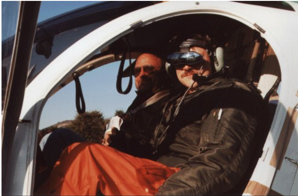
Bild 4 : Pilot mit der Cyberbrille zur Datenvisualisierung und Navigationsunterstützung
